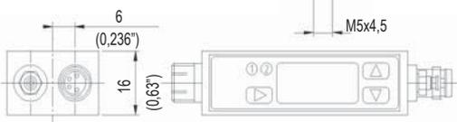
Если реле используется во влажных условиях исходный порт (для давления окружающей среды исходного соединения) должен быть подключен к отводному патрубку (ø 3 мм) с выходом в сухую среду.
