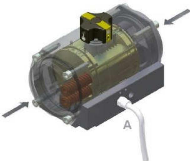
При стравливании воздуха из полости пневмоцилиндра, пружины во внешних камерах разжимаются, возвращая поршни в начальное положение. Пружины перемещают поршни в противоположных направлениях, при этом вал привода вращается по часовой стрелке.
