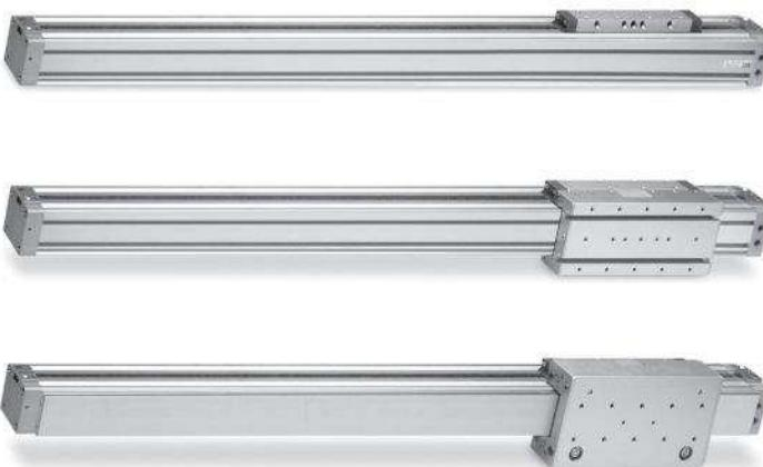
Бесштоковые цилиндры Серии 52 доступны с диаметрами 25, 32, 40, 50 и 63 мм в трех исполнениях: стандартное (M), исполнение с подшипником скольжения (G) и подшипником качения (R). Кроме того, цилиндры производятся со стандартной и укороченной кареткой. Цилиндры могут поставляться с подводами воздуха в обе полости расположеннымными в одной крыше.
