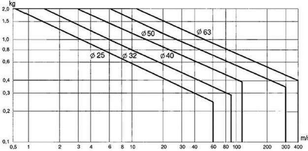
Регулировочным винтом устанавливается мягкое торможение в конце хода. В системах, неудовлетворяющих значениям приведенной диаграммы, необходимо использовать внешние амортизаторы. Амортизаторы должны располагаться с учетом центра тяжести. Диаграмма относится к горизонтальному перемещению.
