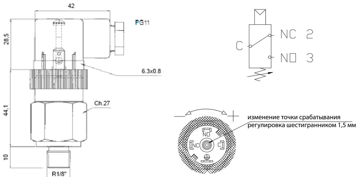
Разъём Мод. 124-830 для регулируемого реле давления Мод. PM...SC.
