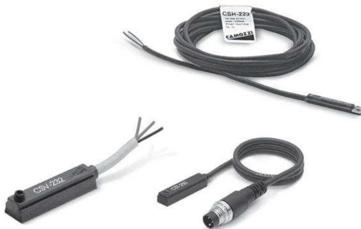
Магнитные датчики положения Серии CST-CSV-CSH служат детектором положения поршня цилиндра. Под воздействием магнитного поля поршня замыкается внутренний контакт датчика, и электрический сигнал выдается в цепь электрической катушки клапана или на вход PLC. О замыкании контакта информирует светодиод желтого цвета.
